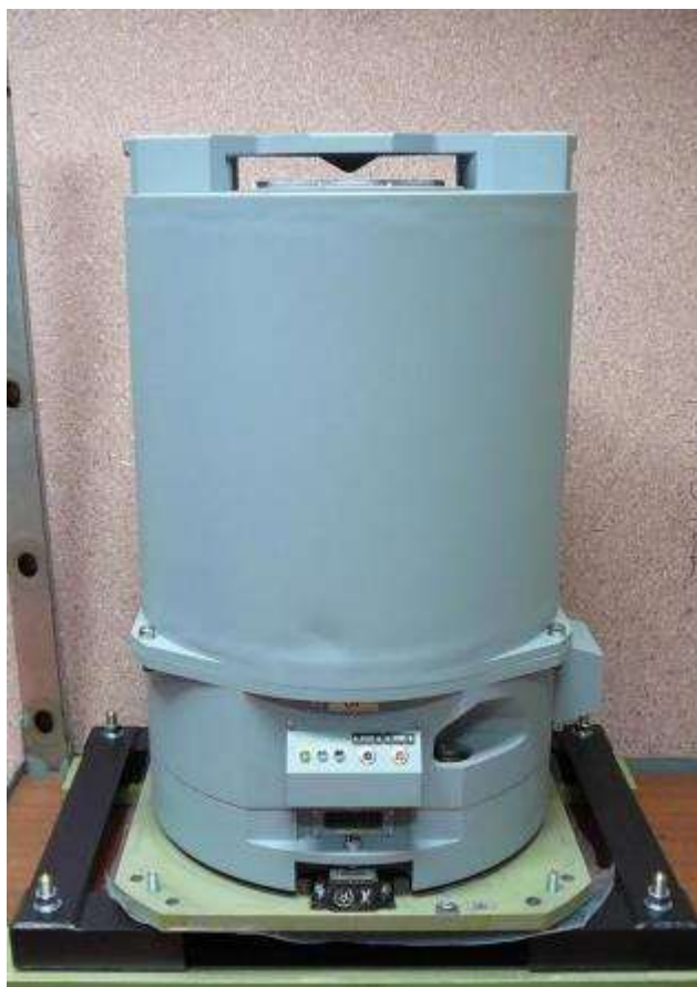
Рис.22. Гравиметр Чекан-АМ модификации "Шельф"
