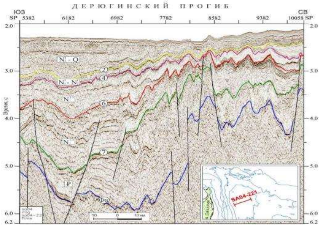
Рис. 10. Фрагмент временного сейсмогеологического разреза по профилю SA04-221.
