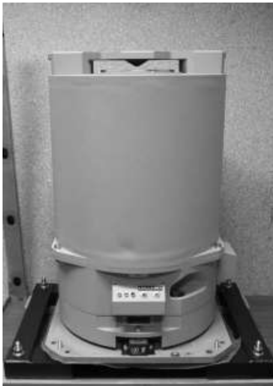
Рисунок 1.4-3 Гравиметр Чекан-АМ модификации "Шельф"
