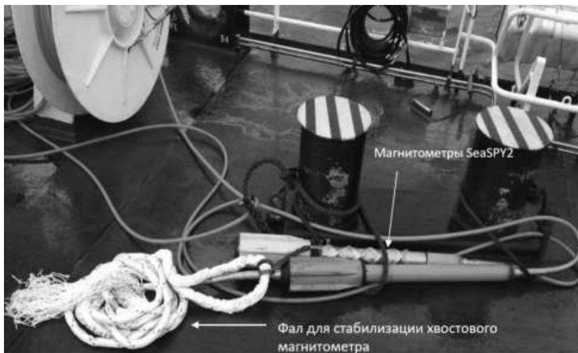
Рис.24. Магнитометры SeaSPY2 в походном положении на НИС Николай Трубятчинский (градиентометр).
