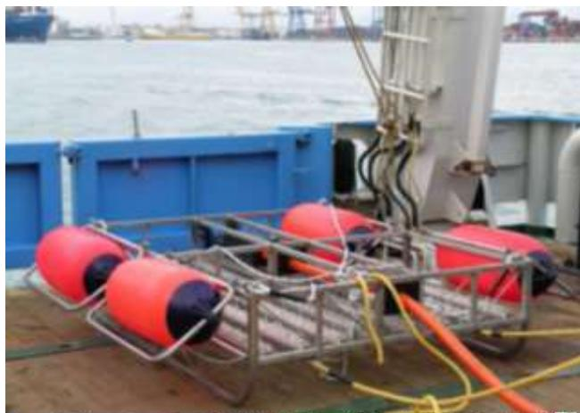
Рисунок 4.3-3 Geo-Boomer 300-500 (слева) и Спаркер Geo-Source 1600 (справа), размещенные на катамаране
