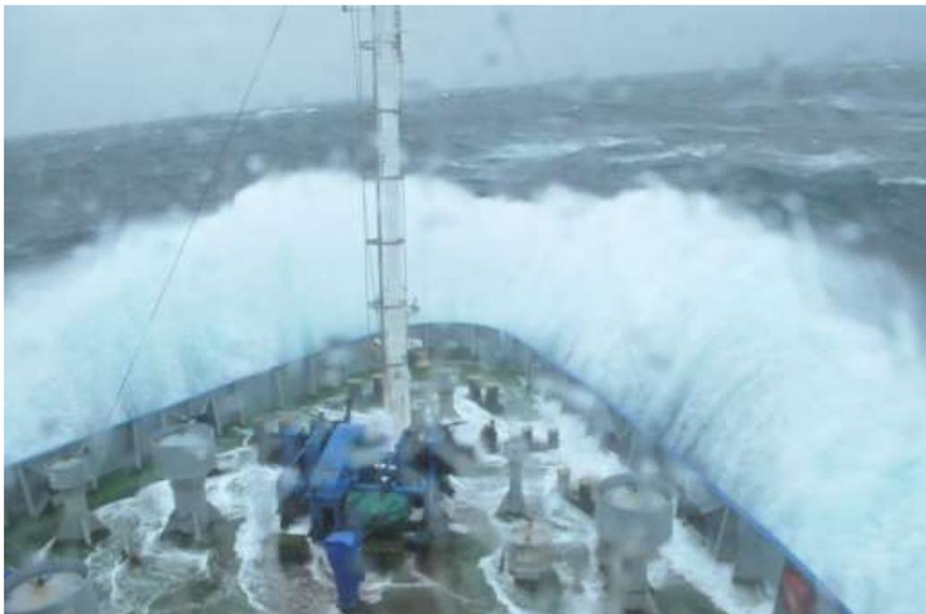
Рисунок 4.5-5 Захлест палубы штормовыми волнами
