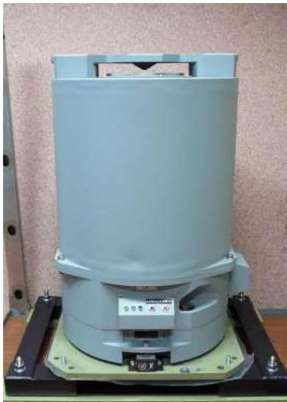
Рисунок 1.4-3 Гравиметр Чекан-АМ модификации "Шельф"
